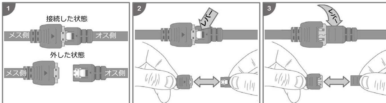
**図1:** コネクタはグローブの内袖にあります。上図に接続した状態と外した状態を示します。
