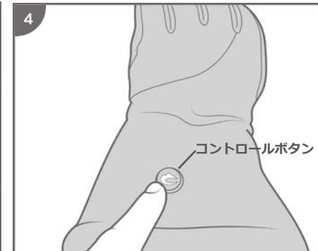
図4: コントロールボタンが点灯するまで3秒間長押しすると発熱が始まります。さらに3秒間長押しするとコントロールボタンが消灯し発熱が停止します。
