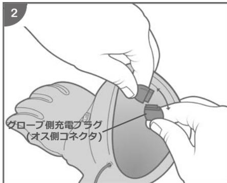
図2: 「コネクタの接続解除」に従ってコネクタの接続を解除してください。コネクタのオス側（小さい方）がグローブ側充電プラグになります。
