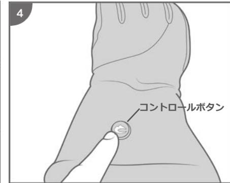
図4: コントロールボタンが点灯するまで3秒間長押しすると発熱が始まります。さらに3秒間長押しするとコントロールボタンが消灯し発熱が停止します。
