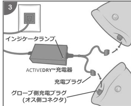
図3: ACTIVE DRY™ 充電器の充電プラグとグローブ側充電プラグを接続すると自動的に充電が開始されます。
